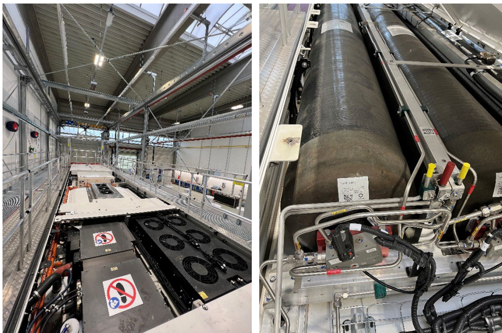
Abbildung 3-3 Dachaufbau und Druckgasbehälter eines Brennstoff- zellenbusses
