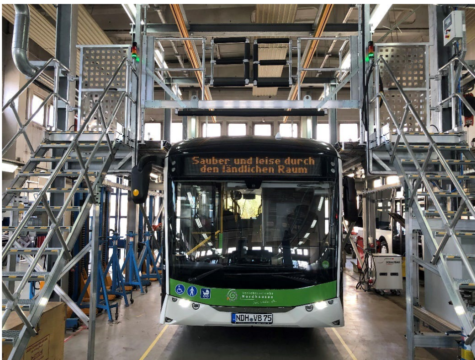
Abbildung 5-1 Dacharbeitsstand samt Portalkran
