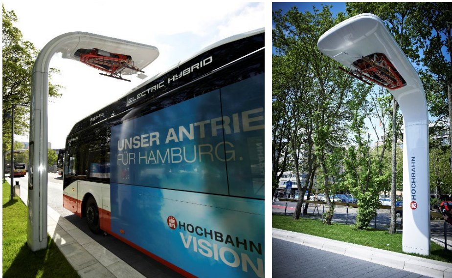
Abbildung 2-15 Ladestation für eine konduktive Energieübertragung an Endhaltestellen, aufgenommen an der Endhaltestelle der Linie 109 in Hamburg; Hersteller / Quelle: Siemens AG
